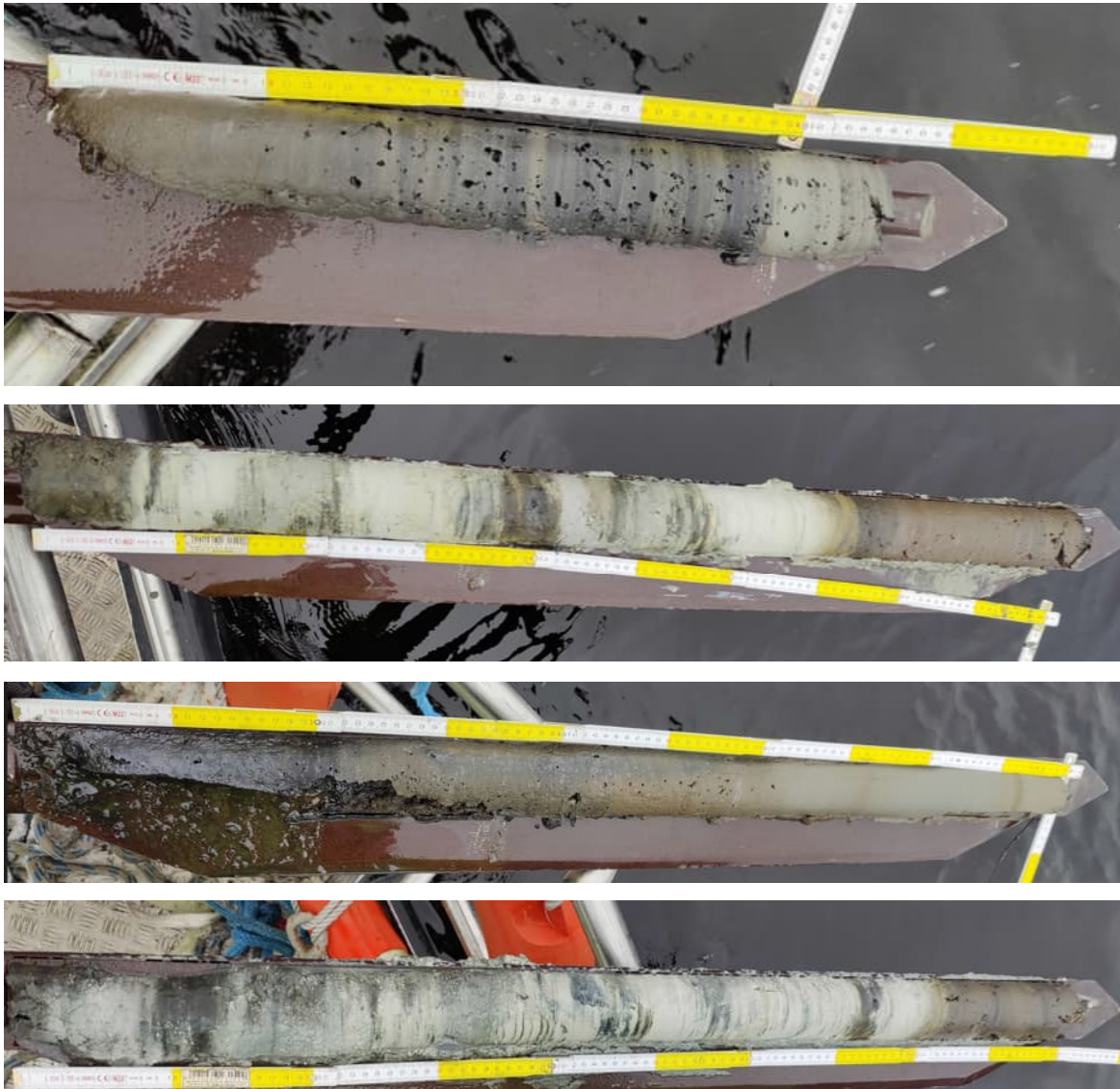
Kuva 9. Kooste täyttöalueelta C vuonna 2024 otetuista pintasedimenttinäytteistä (ulottuma enimmillään noin metrin sedimentin pinnasta). Ylin kuva: piste 3013. Noin 50 cm liejua, jonka alin noin 5 cm muuttuu silttisemmäksi. Toiseksi ylin kuva: piste 3014. Ylin noin 80 cm kalkkisakkaa ja liejua. Väli 80-100 cm liejua. Toiseksi alin kuva: piste 3015. ylin noin 60 cm liejua. Väli 60-100 cm savea. Alin kuva: piste 3016. Ylin noin 80 cm kalkkisakkaa. Väli 80-100 cm liejua.
