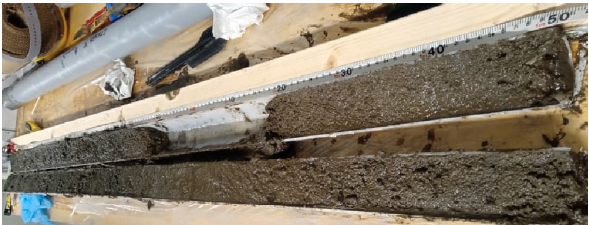
Kuva 8. Näytesarja täyttöalueen C edustalla, täyttöalueen ulkopuolella syvämmässä vedessä sijaitsevasta pisteestä GTK5. Koko noin 145 cm näyte on liejua (kerroksen pohjaa ei näkyvissä).
