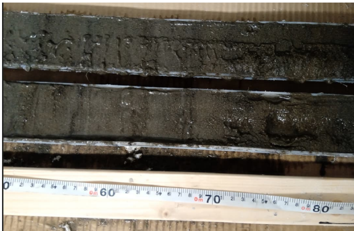
Kuva 3. Näytesarja pisteestä GTK2. Ylin kuva: Ylin noin 30 cm sisältää hiekkaa, soraa ja enemmän orgaanista ainesta. Syvyysväli noin 30-100 cm on siltti- ja hiekkavaltaista ainesta. Noin 100 cm syvyydellä alkaa tiivis, häiriintymätön savi (näyte päättyy noin 2,1 m syvyyteen, savikerroksen pohjaa ei näkyvissä). Keskimäinen kuva: Orgaanisriikkaamassa pintakerroksessa on havaittavissa hiekka- ja sorarakeita. Alin kuva: siltti- ja hiekkayksikössä on havaittavissa runsaasti kiillemineraaleja.
