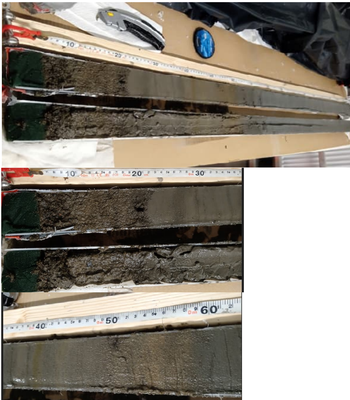
Kuva 2. Näytesarja pisteestä GTK1. Ylin kuva: Ylin noin 20 cm sedimentistä on selvästi orgaanisrikkaampaa ainesta. Syvyysvälillä noin 20-70 cm aines on siltti-savivaltaista, ja orgaanisen aineksen määrä on vähäisempää. Seassa on myös hiekkaa. Noin 70 cm:stä eteenpäin aines on tiivistä, häiriintymätöntä savea (näyte päättyy noin 1,6 m syvyyteen, savikerroksen pohjaa ei näkyvissä). Keskimmäinen kuva: Orgaanisrikkaan pintakerroksen muutos syvempiin koheesiomaalajeihin on terävä. Alin kuva: Hiekka näkyy sedimentin pinnassa yksittäisinä rakeina, lisäksi siltin ja saveksen määrä vaihtelee.
